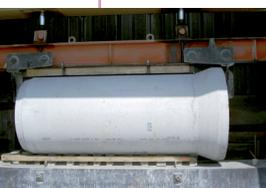
**Pour les tuyaux en béton armé, non armé ou en béton fibré**, la résistance mécanique garantie par la marque NF est calculée en fonction du dimensionnement mécanique des tuyaux et varie de 135, 165 à 200 kN/m.
