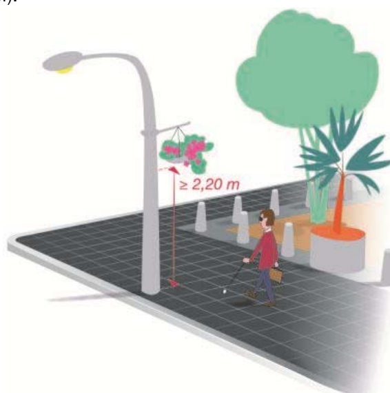
Figure 14 – Exemples de bornes et poteaux contrastés avec l'arrière-plan
