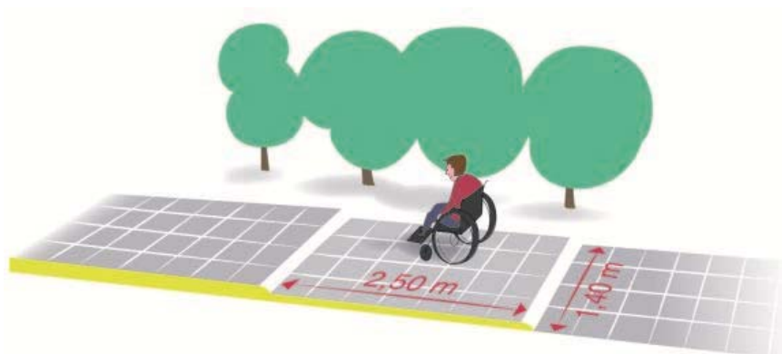
Figure 11 – Distance minimale entre deux ressauts
