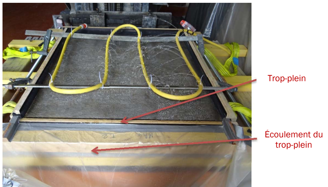
Figure 39 – Photo du trop-plein sur le dispositif d'essai de perméabilité
