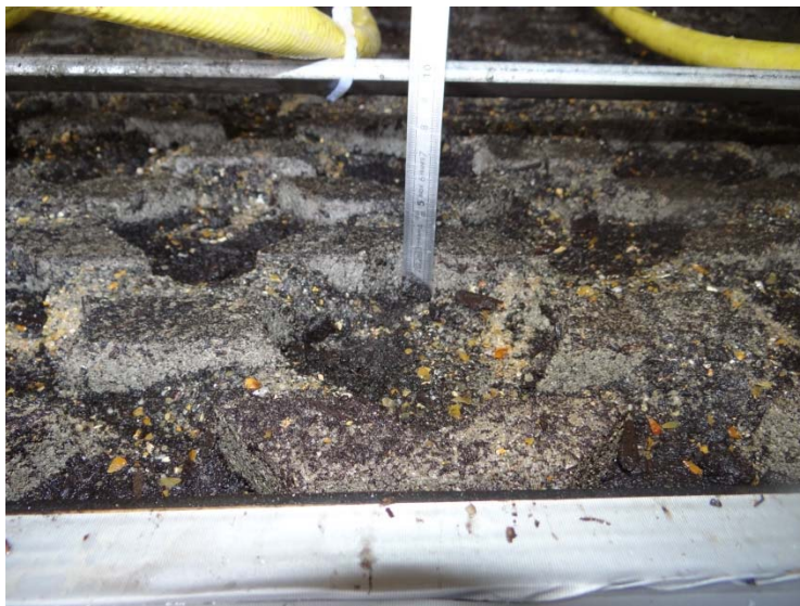
Figure 45 – Tassement naturel du mélange terre-sable sous l'action de l'eau
