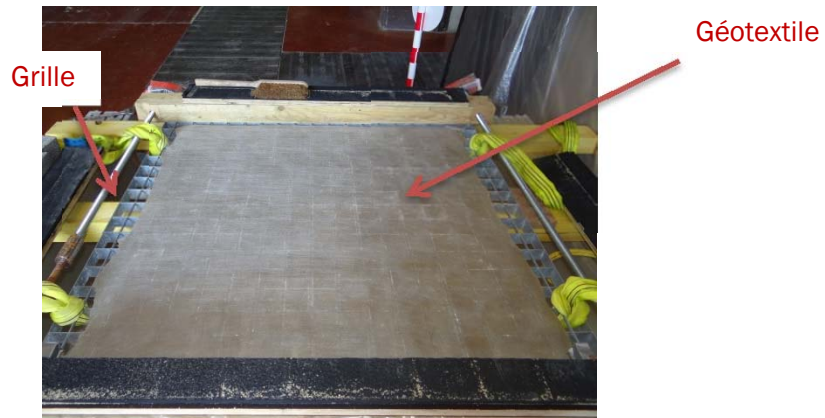
Figure 7 – Géotextile installé sur la grille pour les essais d'infiltration
