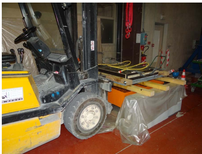
Figure 12 - Insertion du bac de récupération sous la surface d'essai
