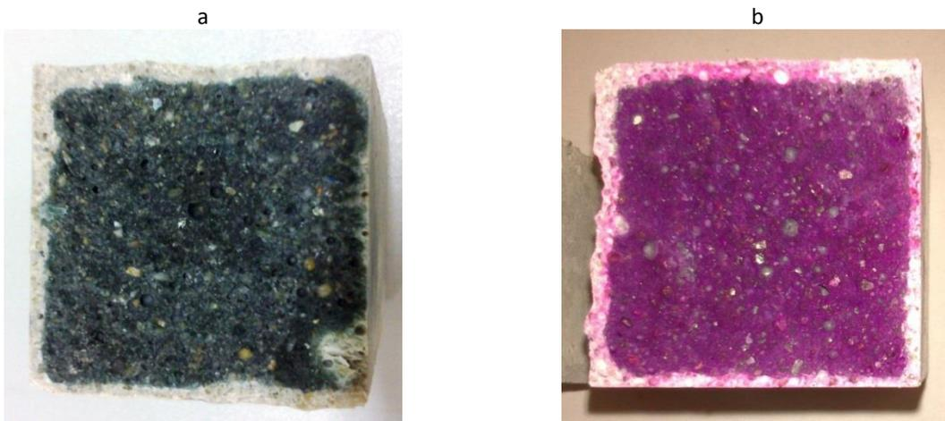
Figure VII.13 : Photographies d'éprouvettes de mortier S + NČ conservée dans l'eau pendant 1 an, a : couleur bleu-vert naturelle, b : couleur après pulvérisation de phénolphaléine
