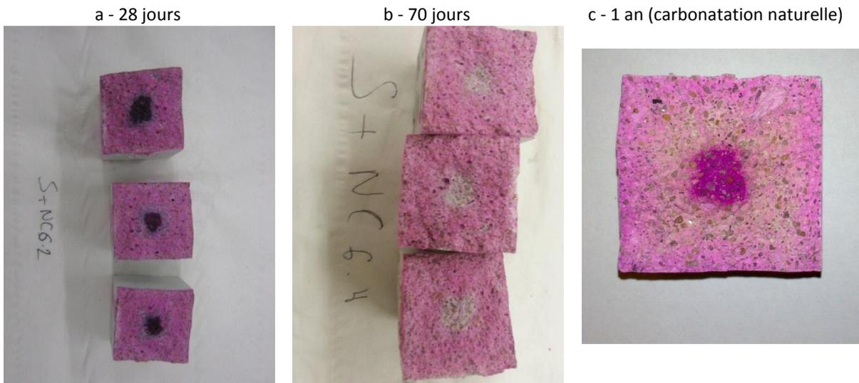
Figure VII.12 : Photographies des éprouvettes du mortier S + NČ6(VD) à diverses échéances de carbonatation
