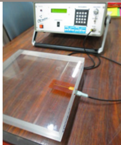
Exemple de mesure sur plaques de verre (Matériau étalon)
