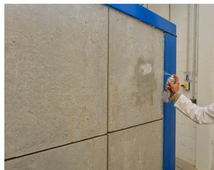
Vérification de l'étanchéité à l'air d'une paroi avec une bombe à mousse
