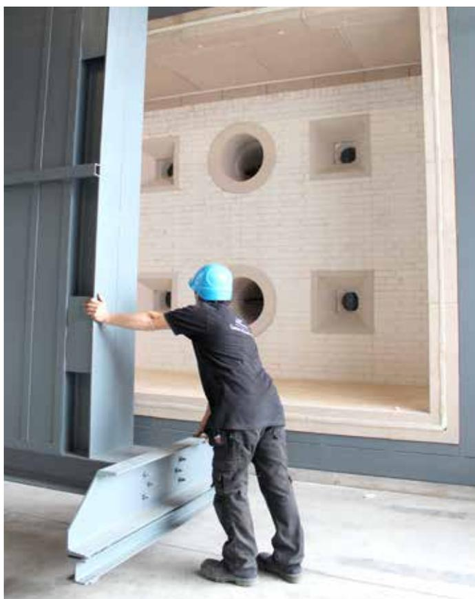
➤ Le Centre d'Essais au Feu se dote d'un nouvel équipement : le four « Combi ». Celui-ci peut tester des corps d'épreuves verticaux et horizontaux, non chargés et non porteurs (murs, portes, fenêtres, cloisons, calfeutrements...), ses dimensions avantageuses (4 m de large sur 3 m de haut et 1 m 30 de profondeur) lui permettant de tester plusieurs éléments en un seul essai.
