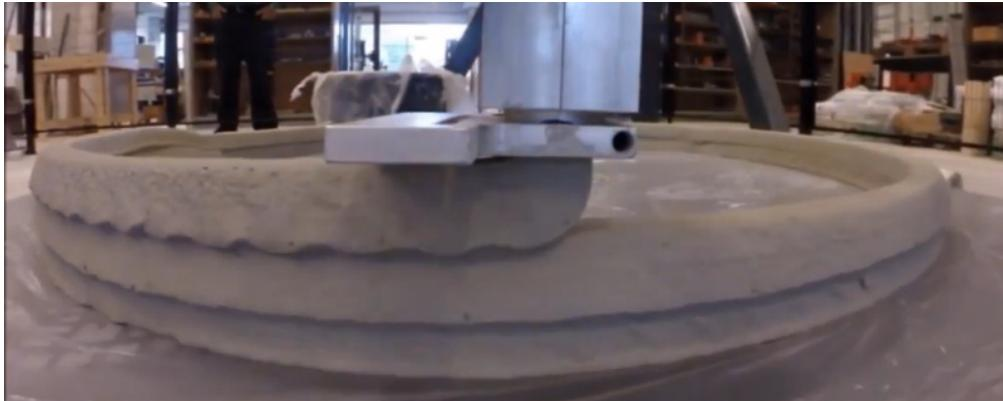
Figure 47 : Le béton est plus fluide que la strate inférieure et coule [62]
