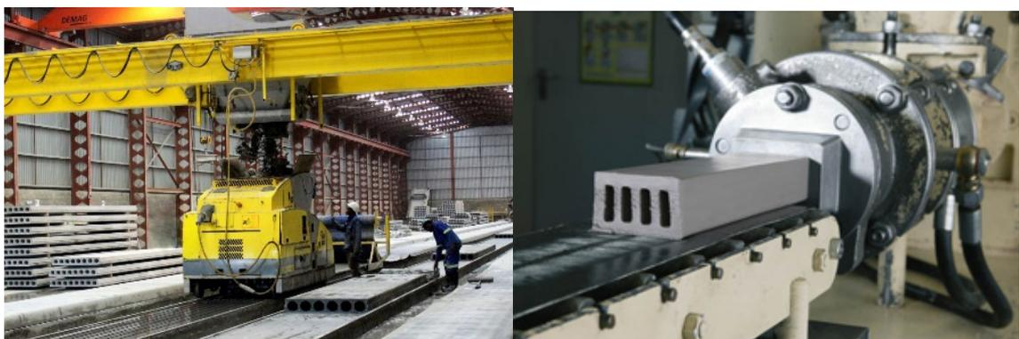
Figure 26 : Exemples de procédé d'extrusion [50 et 51]
