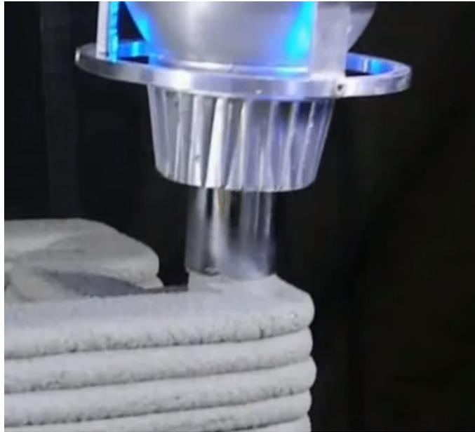
Figure 34 : Exemple de buse d'extrusion [58-59] machine conçue par Andrey Rudenko
