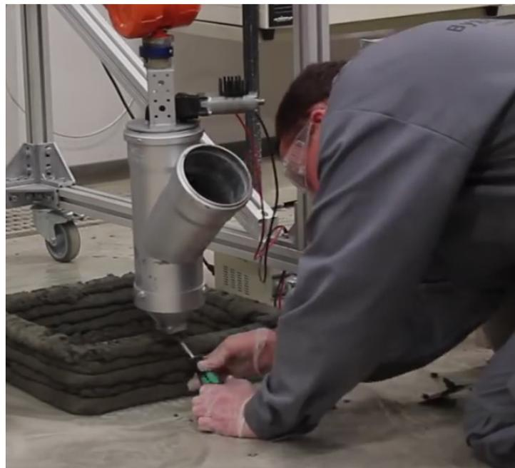
Figure 46 : Dégagement du bouchon de l'extrudeuse [64]
