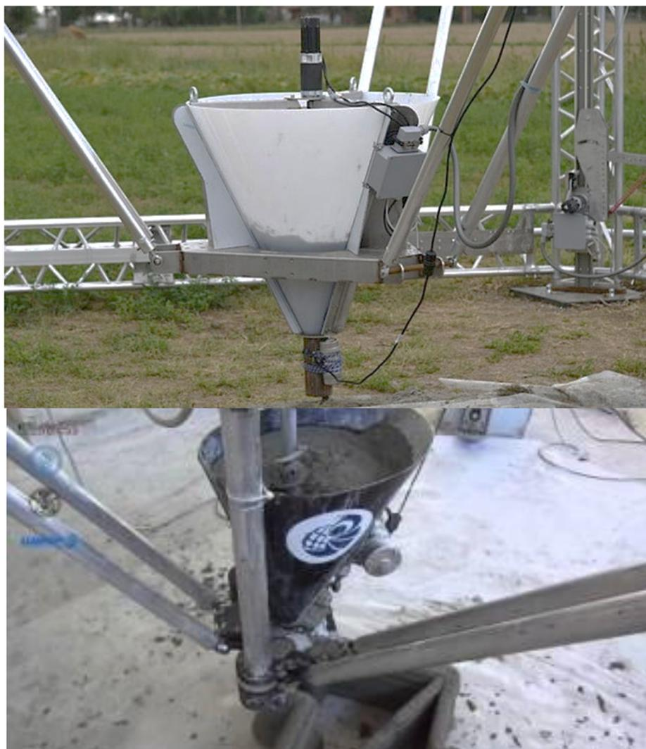
Figure 39 : Exemple de moyen d'extrusion simple [63]
