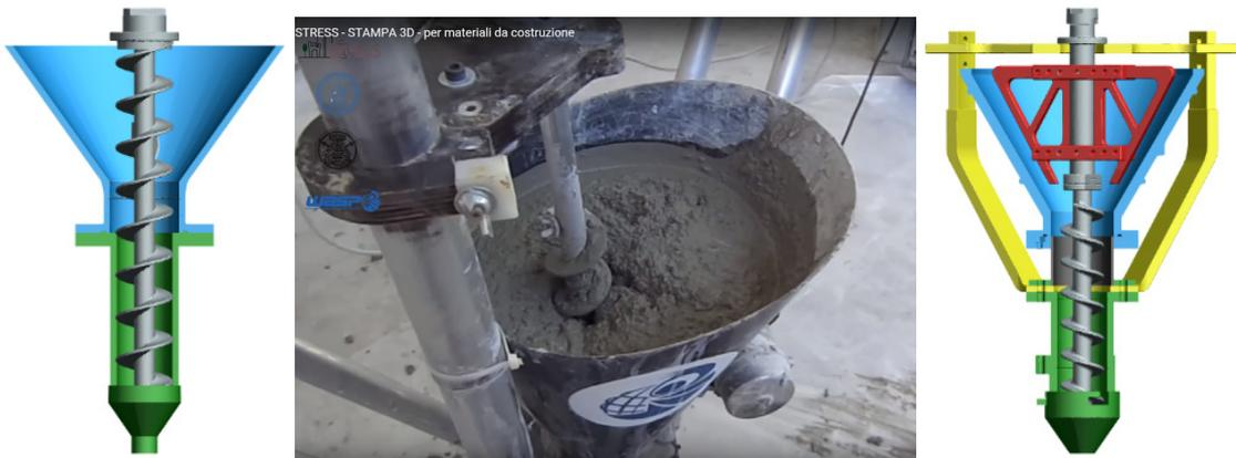
Figure 40 : Zoom sur le système à vis sans fin [63]
