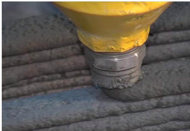
Figure 35 : Exemple de buse basique [60]
