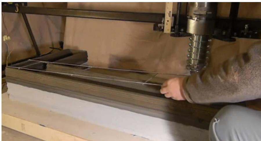
Figure 43 : Mise en place de renforts métalliques, manuellement, pour assurer la rigidité de la structure, dans le cas du château d'Andreu Rudenko [58]
