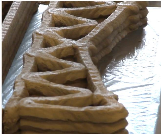
Figure 48 : Affaissement des strates et formations de boursouffures [62]
