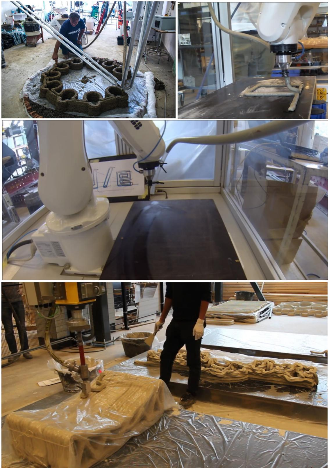
Figure 42 : Exemples de systèmes d'extrusion via une pompe [52, 62, 63]
