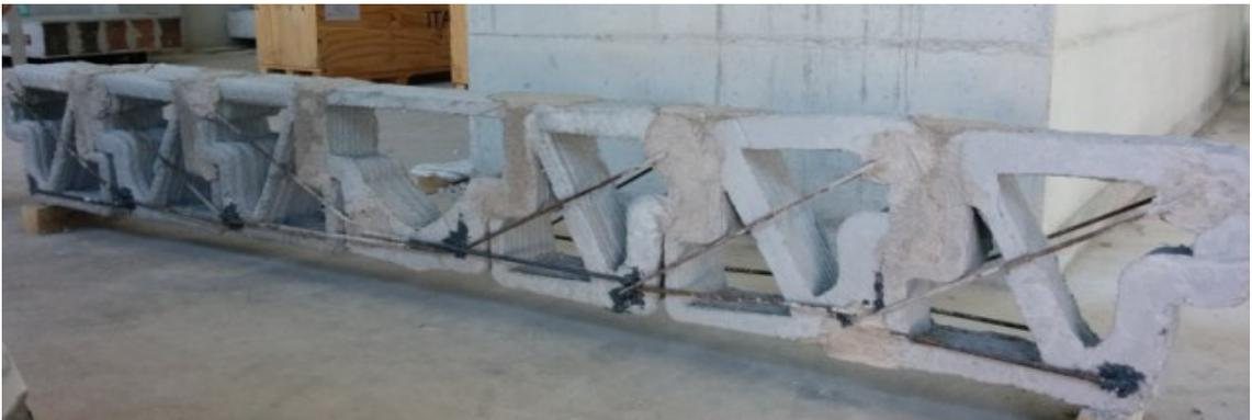
Figure 11 : Poutre imprimée en béton
