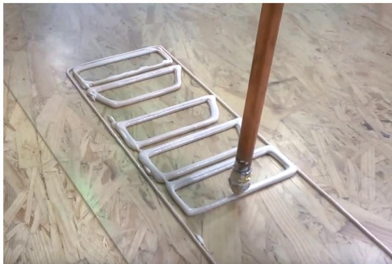
Figure 24 : Béton composite imprimé [48]
