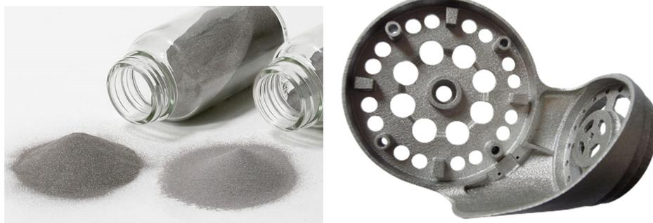
Figure 9 : Poudre de fer et d'aluminium et structure métallique imprimée [19]
