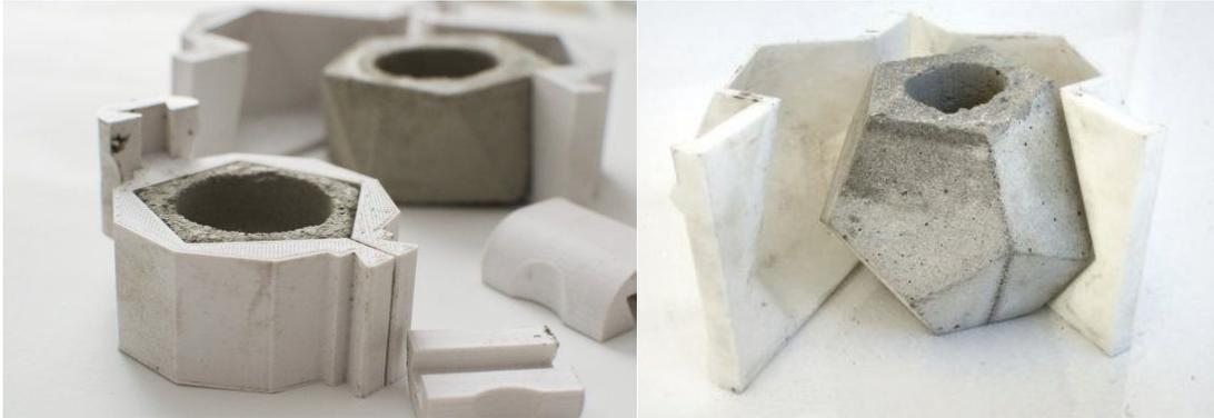
Figure 50 : Exemple de moule de petite dimension imprimé [80]
