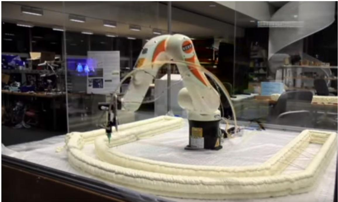
Figure 25 : Exemple de matériau composite déposé par projection [49]
