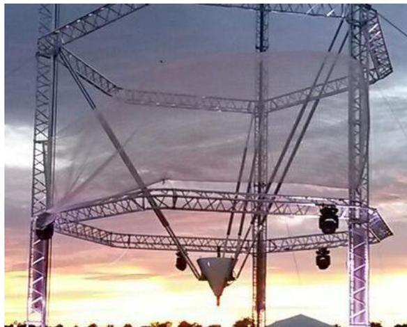
Figure 31 : Robot parallèle Delta de la société WASP [20]
