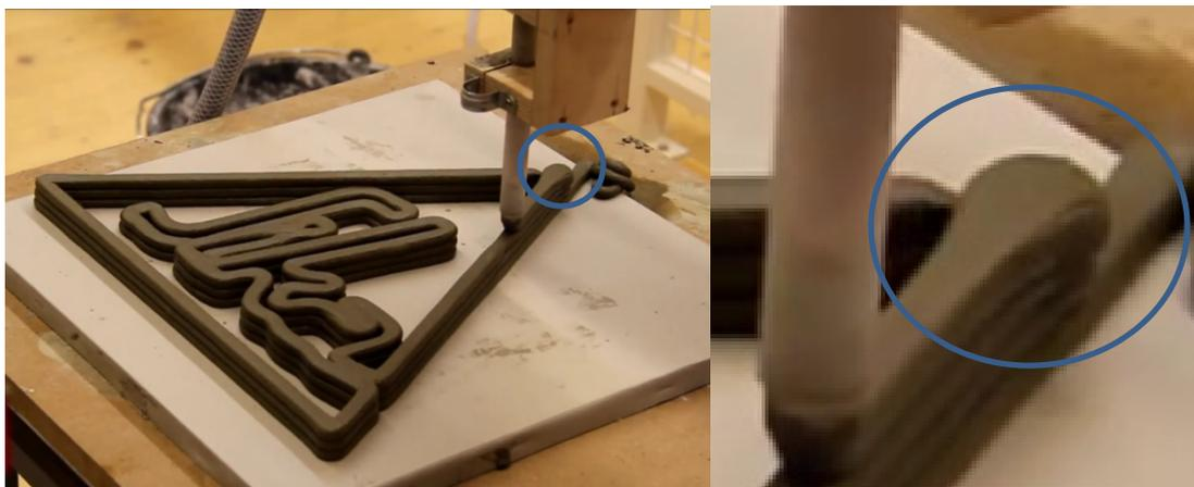
Figure 49 : Exemple de sur-remplissage lors de la reprise d'impression [47]
