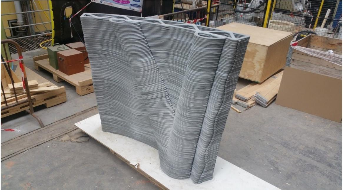
Figure 12 : Mur imprimé en BHP [21]
