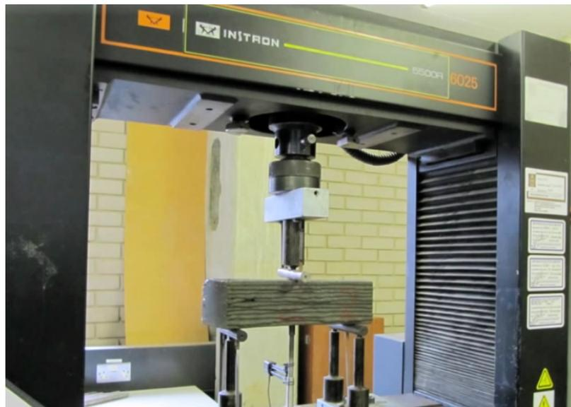
Figure 45 : Essais de flexion dans le sens perpendiculaire des strates [79]
