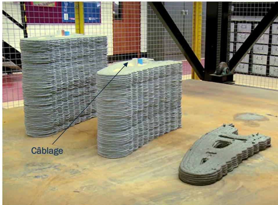
Figure 21 : Exemple de produit imprimé [30] avec des réservations
