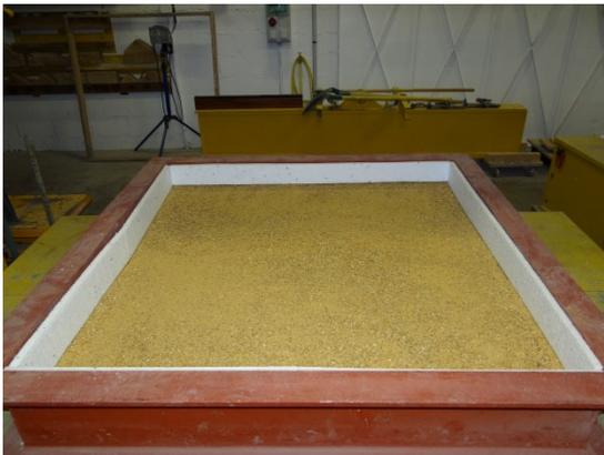
Photo 3 - Lit de pose de 3 cm en sable 0/4 mm
