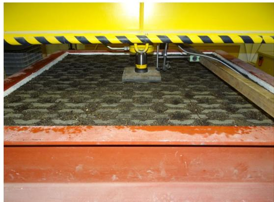
Photo 6 - Essai sur dalles drainantes engazonnées ou gravillonnées humides
