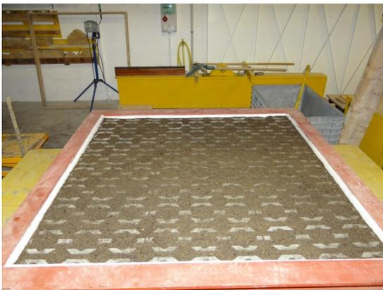
Photo 5 - Remplissage des dalles drainantes engazonnées ou gravillonnées, mélange terre-sable
