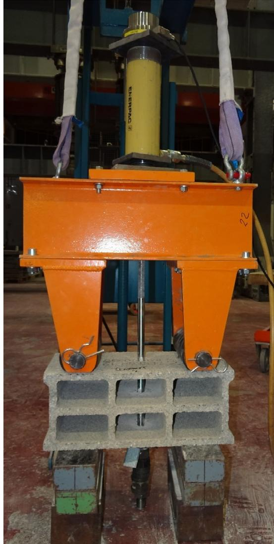
Figure 2 – Dispositif d'essai pour l'essai de poinçonnement
