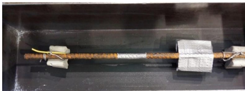
Figure 12 – Photographie d'étiquettes RFID (n° 17a et 18) attachées à l'armature et bien positionnées avant coulage dans une éprouvette de béton 10*10*40 cm³
