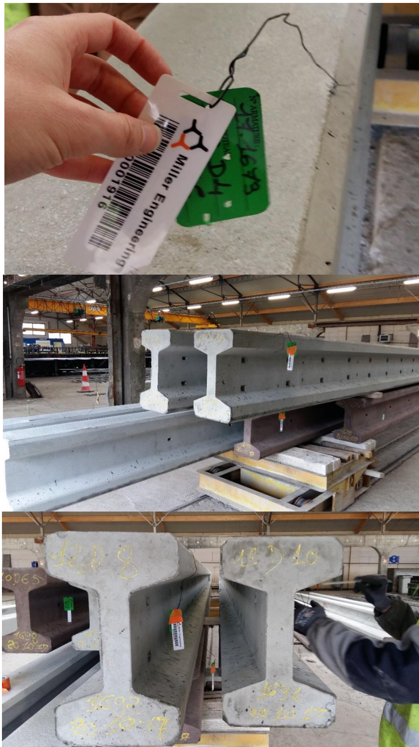
Figure 18 – Étiquettes positionnées sur les poteaux testés
