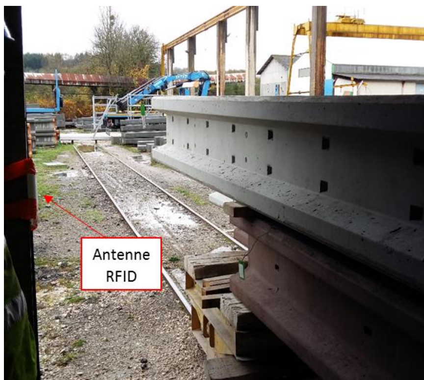
Figure 17 – Installation du système RFID sur le portique de sortie de l'atelier
