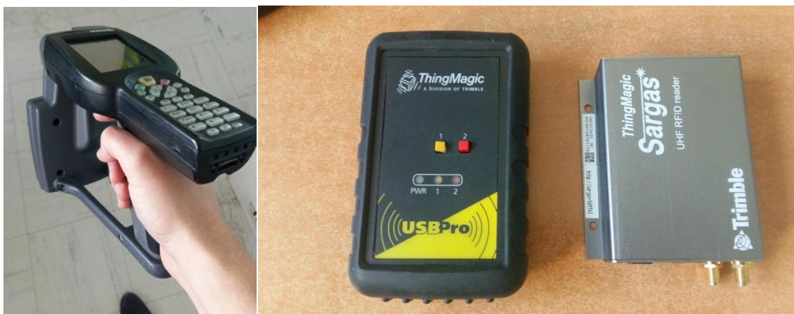
Figure 5 – Trois lecteurs UHF RFID testés
