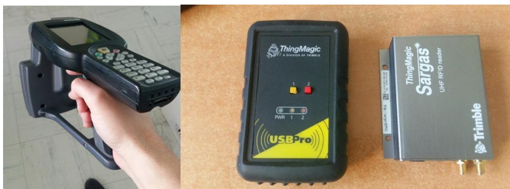
Figure 23 – Trois lecteurs UHF RFID testés
