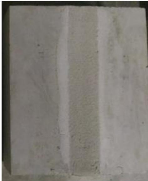
Figure 15 – Évidement rempli par le produit de joint
