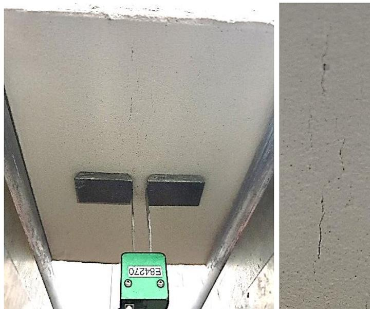
Figure 18 – Fissuration de l'enduit lors d'un essai de flexion
