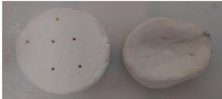
Figure 11 - Produit J1 sec (gauche) et imbibé d'eau (droite)
