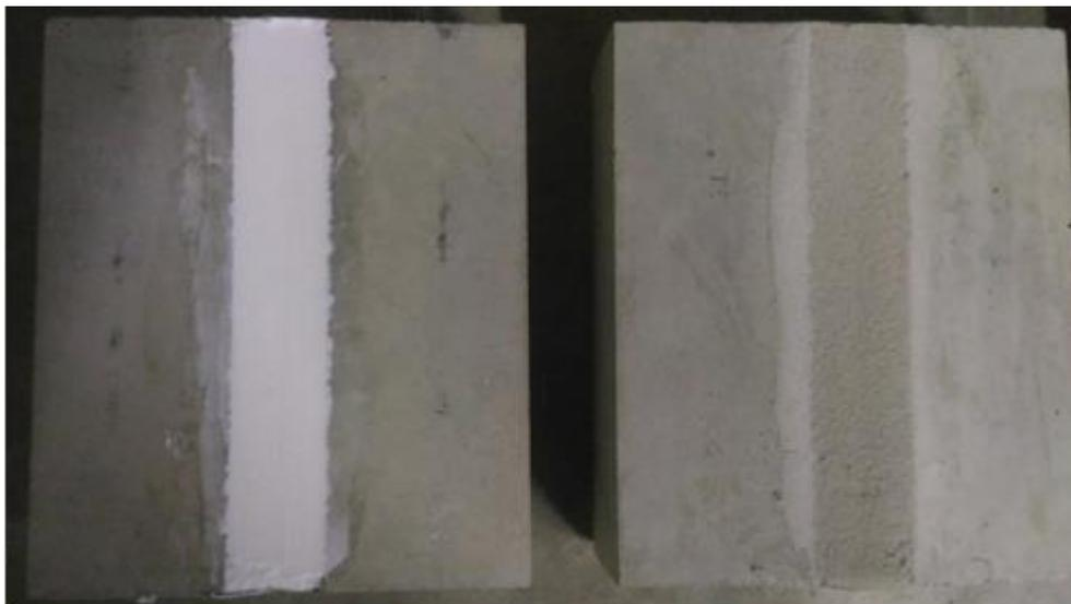
Figure 10 - Photographies des éprouvettes après pose des joints
