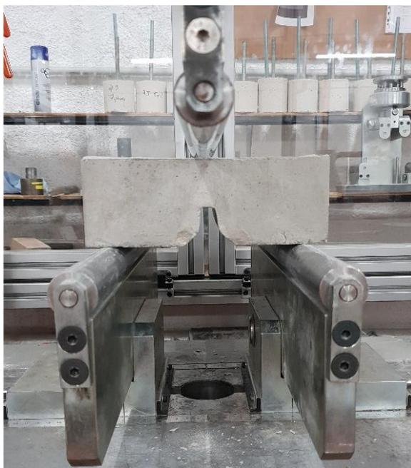
Figure 9 – Opération de pré-fissuration de l'éprouvette avant pose du joint
