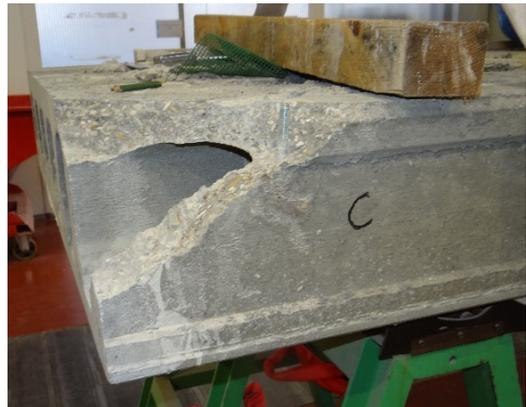
Photo 5 – Endommagement des abouts des dalles alvéolées B et C
