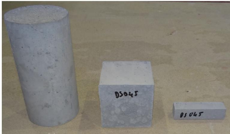
Photo 9 – Epreuves de contrôle de différentes formes
