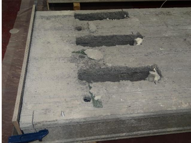
Photo 1 - DAP270 avec 3 alvéoles ouvertes (dalle n° A)
