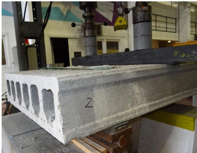
Photo 7 - Dispositif de chargement
