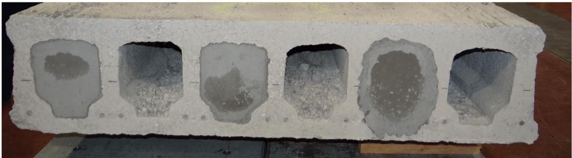
Photo 4 – Visualisation de la section transversale des dalles alvéolées de la série A à C après remplissage des 3 alvéoles
