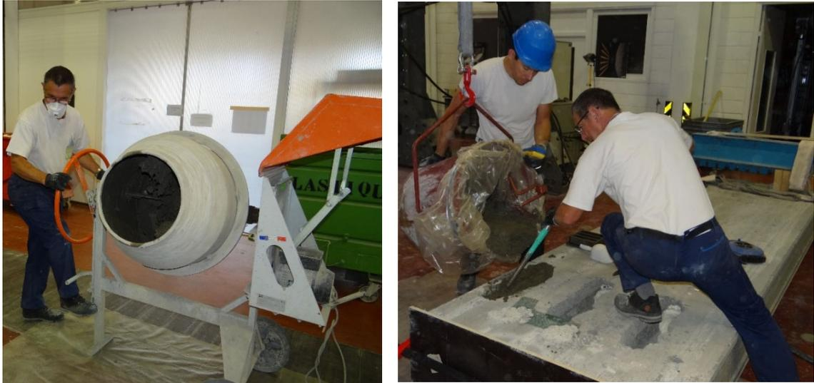
Photo 3 – Remplissage des alvéoles ouvertes des dalles alvéolées de la série A à C
