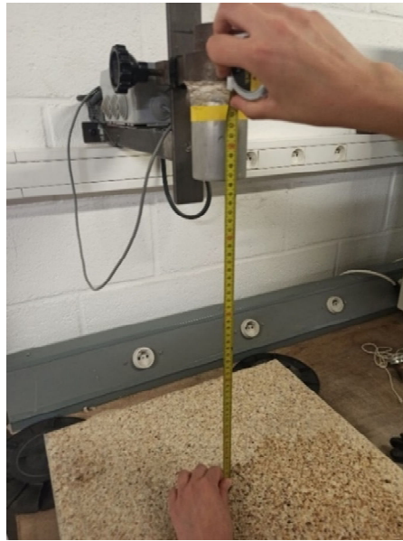
Figure 5 – Vérification de la hauteur de chute verticale de la bille
