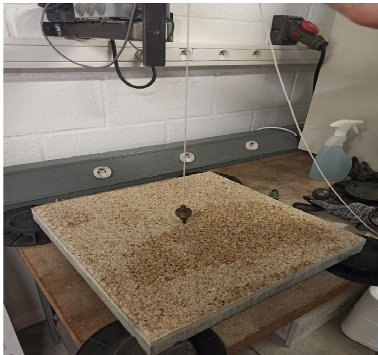
Figure 2 – Pendule permettant de repérer le point d'impact
