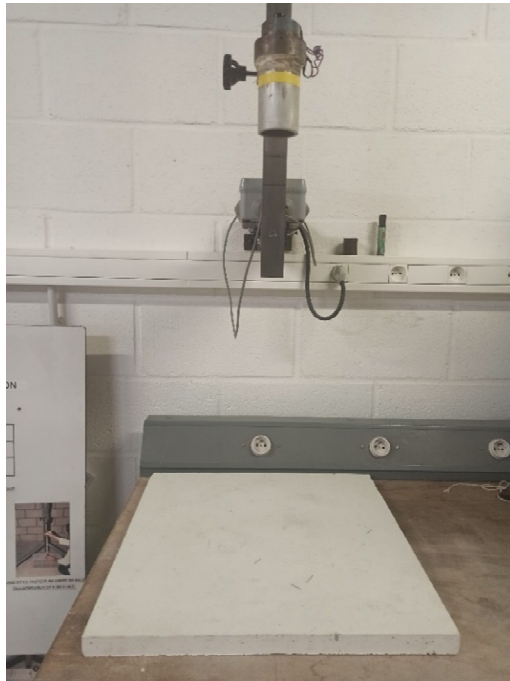
Figure 1 – Support de l'essai de tenue au choc
