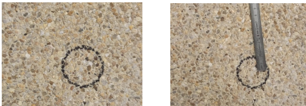
Figure 8 & Figure 9 – Eclats sur une dalle en béton à la suite de l'essai de choc
