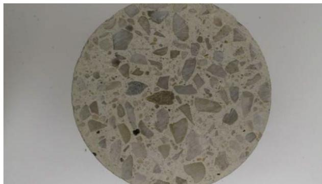
Coupe d'éprouvette cylindrique en béton - ©Cerib
