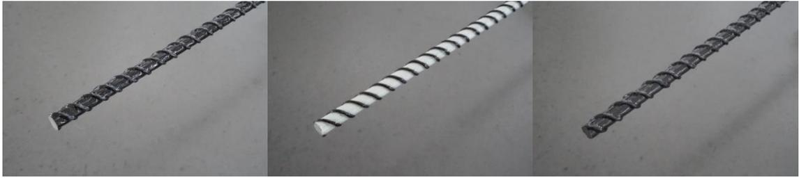
Figure 18 – Armatures de fibres de basalte, fibres de verre et fibres de carbone
