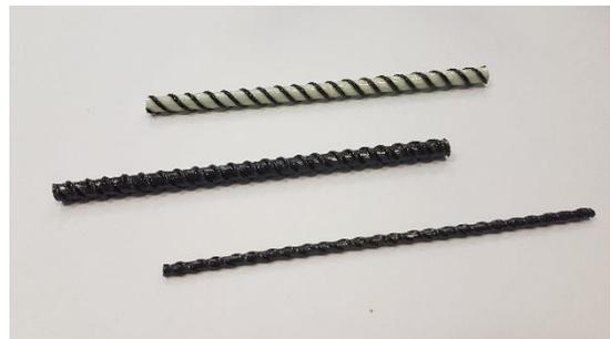
Figure 2 - Armatures en fibres de verre, basalte et carbone (Solidian)
