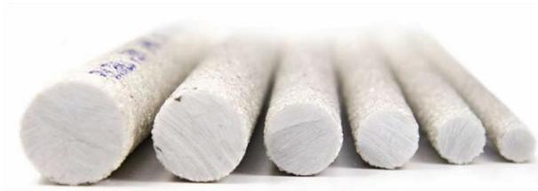
Figure 33 – Barres en fibres de verre
