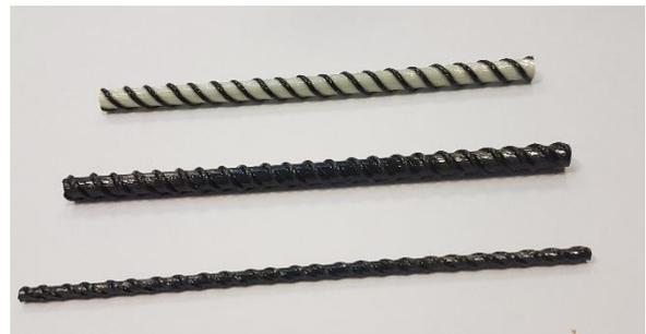
Figure 10 – Barres d'armatures en fibres de verre et de carbone (Solidian)
