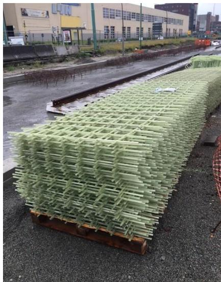
Figure 26 – Treillis Fort-Mesh en fibres de verre
