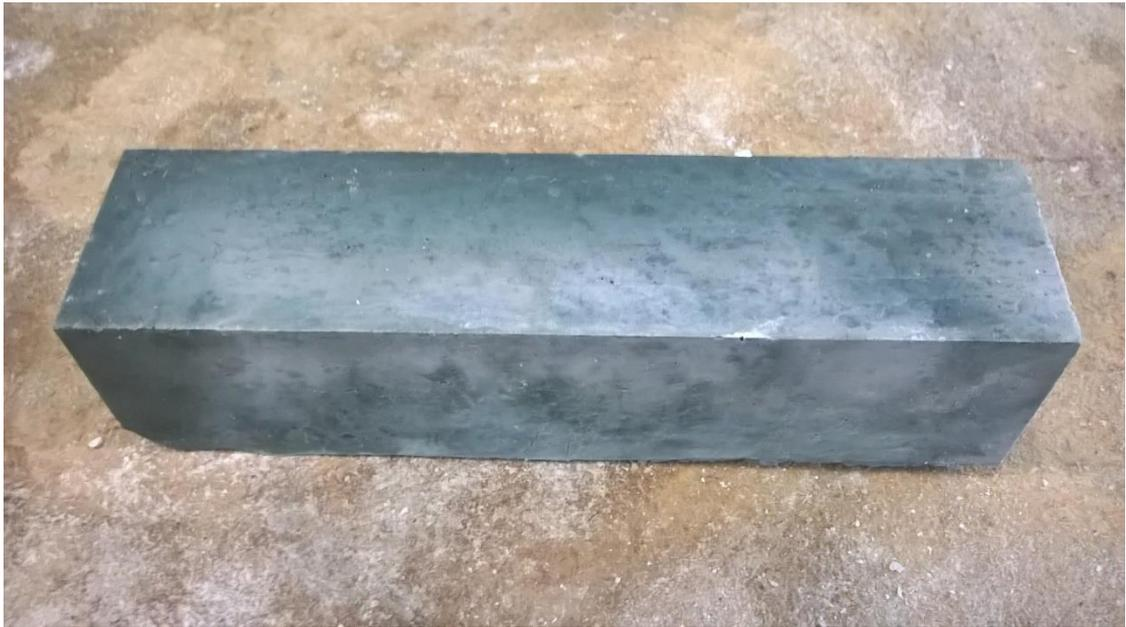
Figure 10 : Éprouvette de béton S + NC6 après traitement thermique
