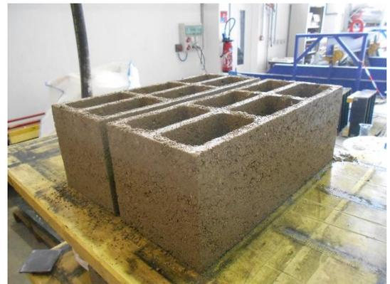
Figure 21 : Blocs à six alvéoles frais fabriqués sur presse au Cerib
