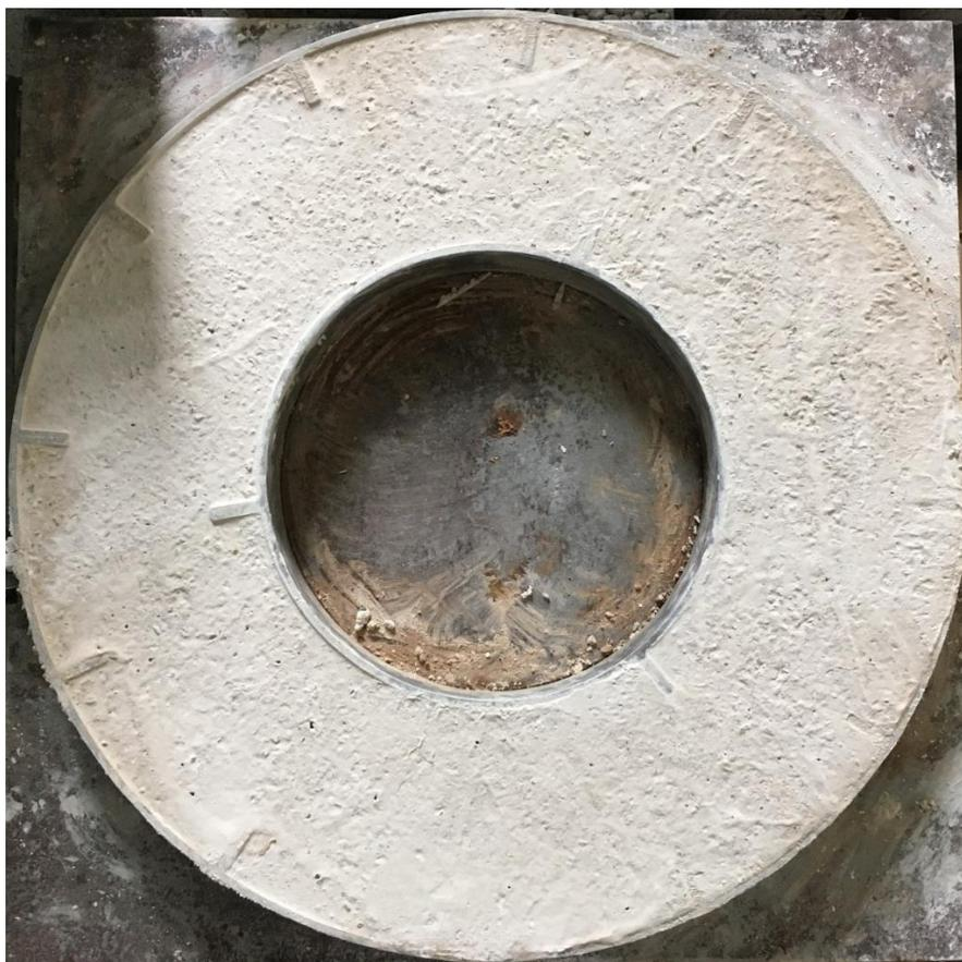
Figure 12 : Essai à l'anneau à 28 jours : pas de fissure observée
