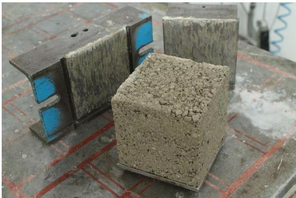
Figure 20 : Cube de béton démoulé immédiatement
