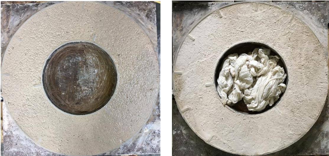
Figure 11 : Essai à l'anneau : pas de fissure observée (à gauche : béton frais avant traitement thermique, à droite : à 8 h à l'issue du traitement thermique)
