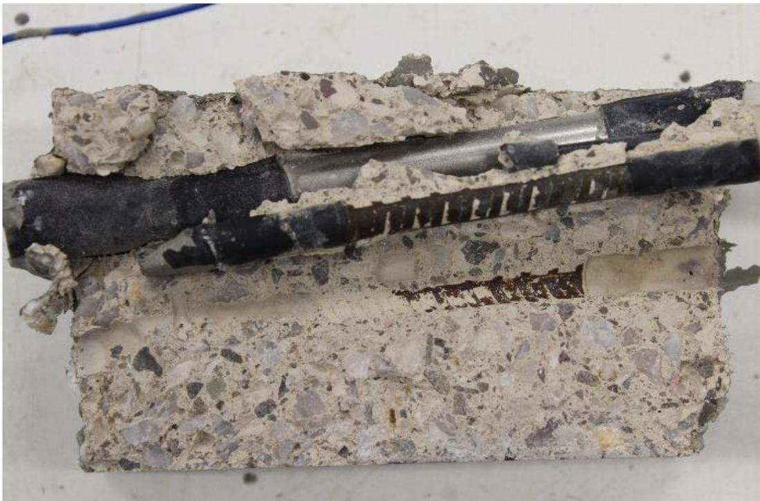
Figure 19 : Inspection visuelle de la corrosion de l'armature de suivi
