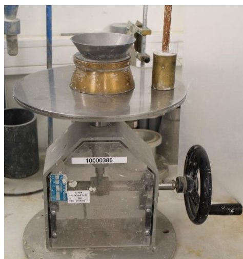
Figure 2.31 Matériel utilisé pour mesurer l'étalement des mortiers
