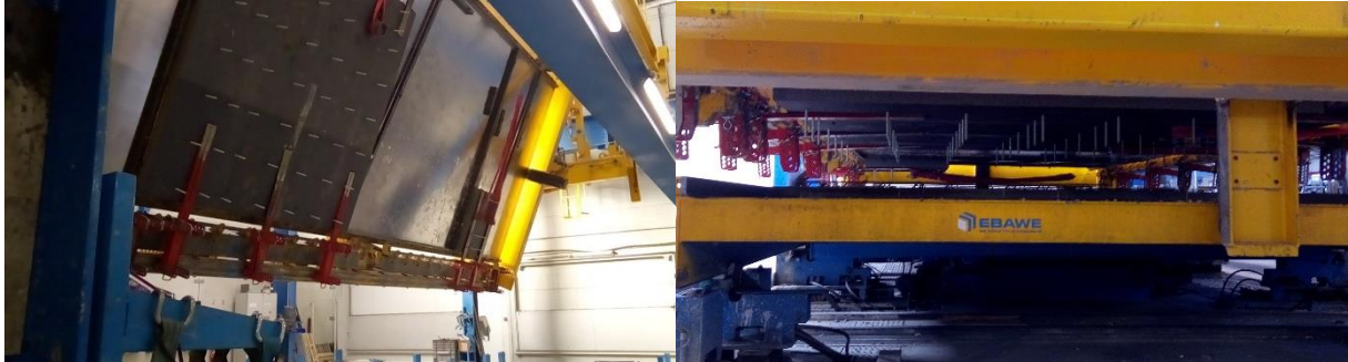
Figure 2.72 À gauche, opération de retournement de la première paroi ; à droite, descente de la première paroi vers la seconde
