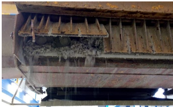
Figure 2.71 À gauche, coulage du béton au sein du moule à l'aide de la trémie ; à droite, vis sans fin permettant d'entraîner le béton frais hors de la trémie
