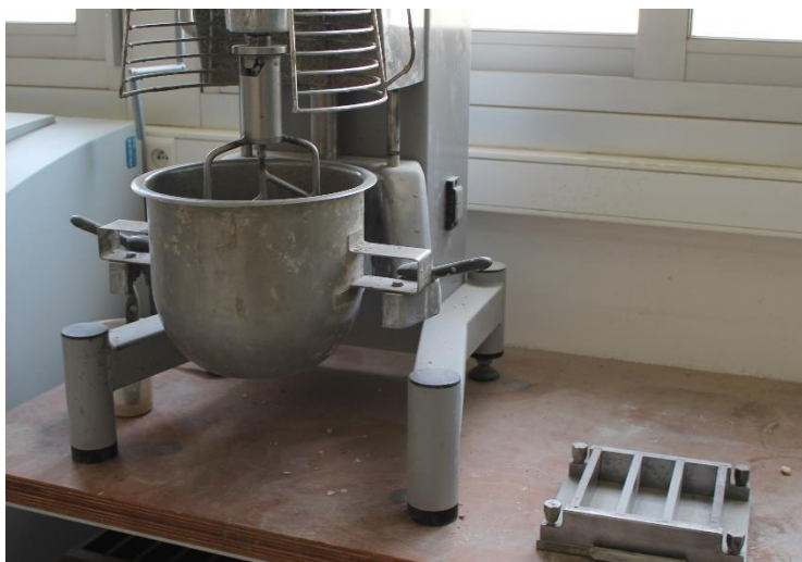
Figure 2.29 Malaxeur et moule utilisé pour la confection des éprouvettes de mortiers normalisés
