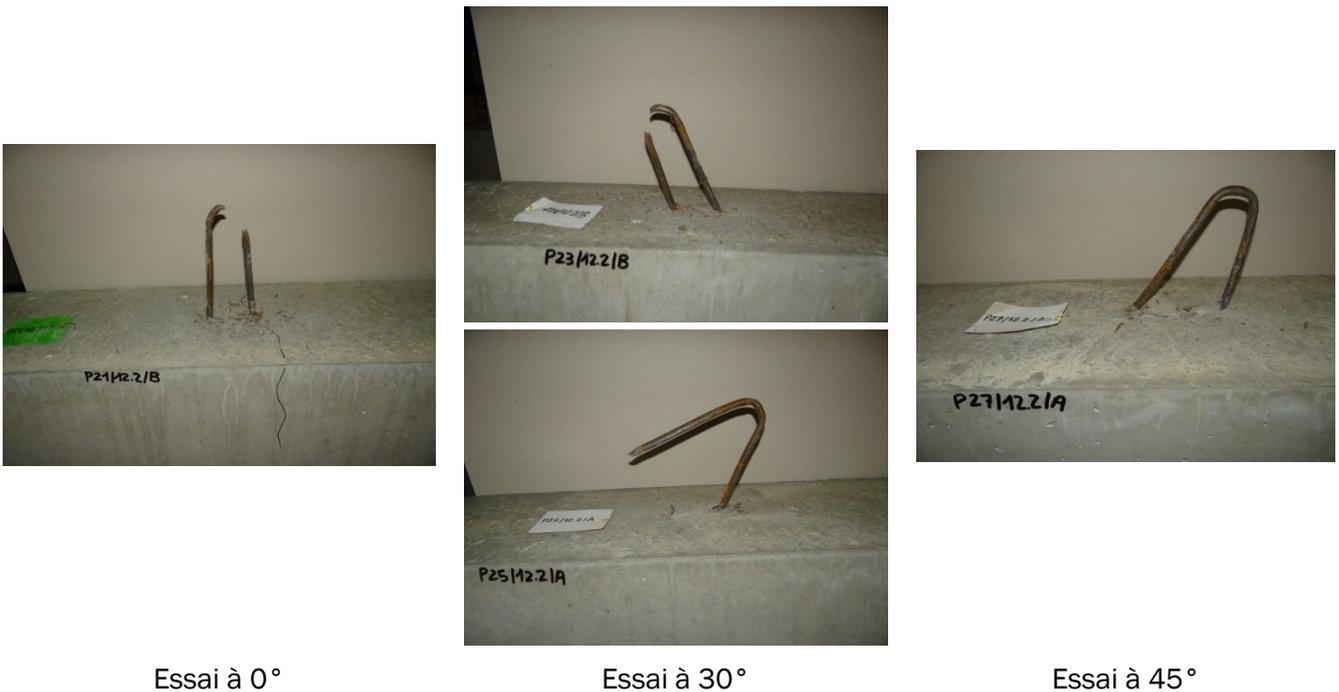
Photo 4 – Exemples de faciès de rupture
