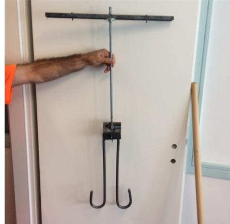
Photo 1 – Dispositif de maintien des boucles pour assurer la hauteur dépassante visée  $H_s$  et l'alignement vertical de la boucle dans la poutre
