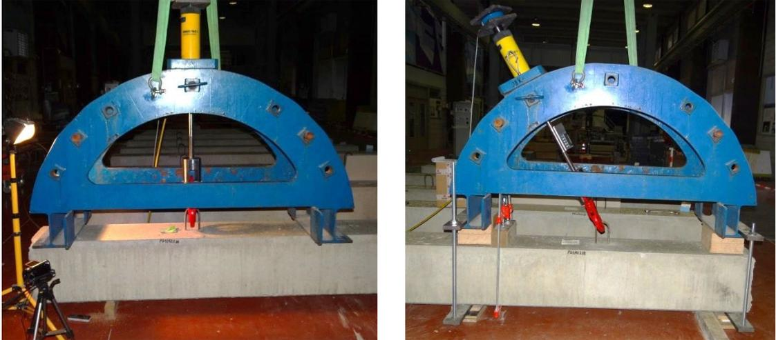
Figure 13 – Dispositif de chargement (à gauche : essai à 0° et, à droite : essai à 30°)
