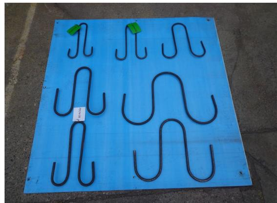
Photo 2 – Photographie de quelques boucles de levage reçues
