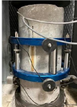
Figure 2 - Instrumentation pour les essais de compression monotones et cycliques
