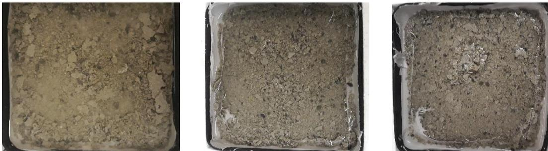
Figure 22 – Pavés de la série M35P35 à l'issue des essais de gel
