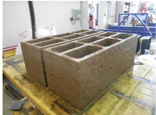
Figure 11 – Blocs creux à 6 alvéoles
