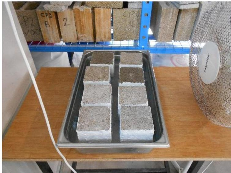
Figure 14 – Essai de capillarité
