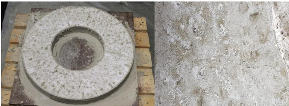
Figure 31 – Observation des fissures
