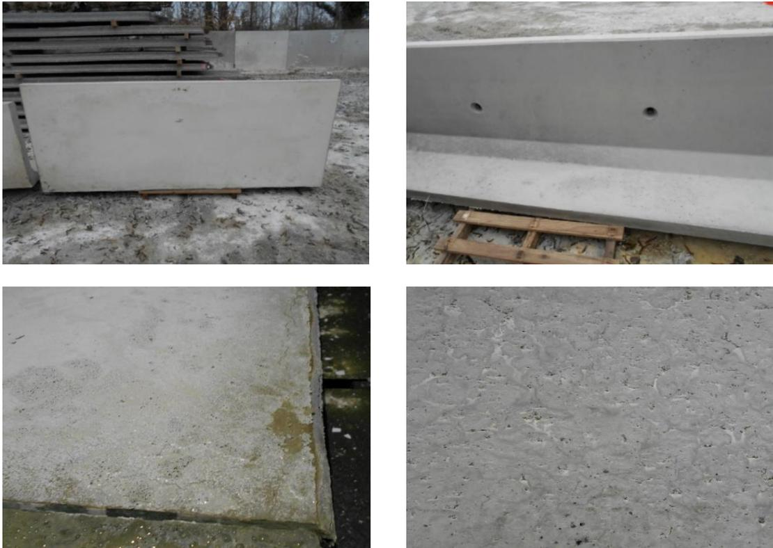
Figure 33 – Photographies des murs coulés avec les bétons décarbonés – Phénomènes de ressuges observés sur le mur fabriqué avec le liant CEM I + S
