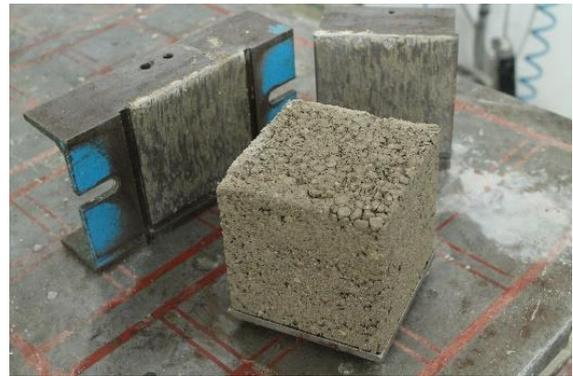
Figure 8 – Démoulage d'une éprouvette
