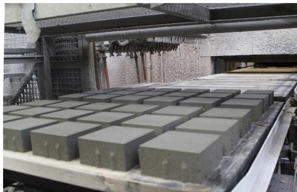
Figure 18 – Production des pavés en usine
