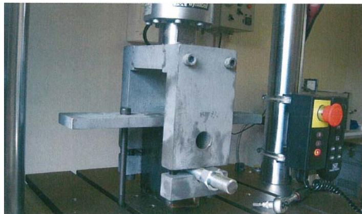
Figure 8 – Photo du dispositif d'assemblage broché dans la machine d'essai
