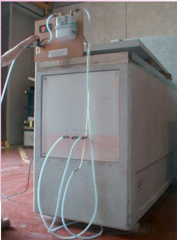
Essai de perméabilité à l'air (caveau + filtre).
