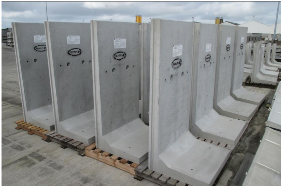
Murs de soutènement en béton sur le parc de l'entreprise THÉBAULT
