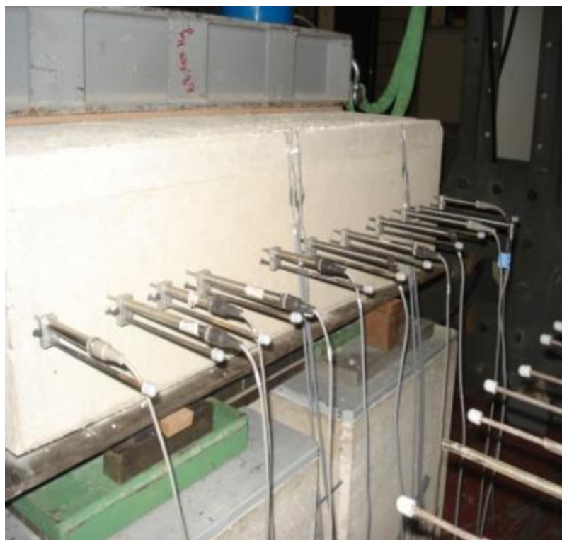
Photo 9 : Mesure en continu du glissement des fils par des capteurs de déplacement fixés sur la longueur dépassante des fils.
