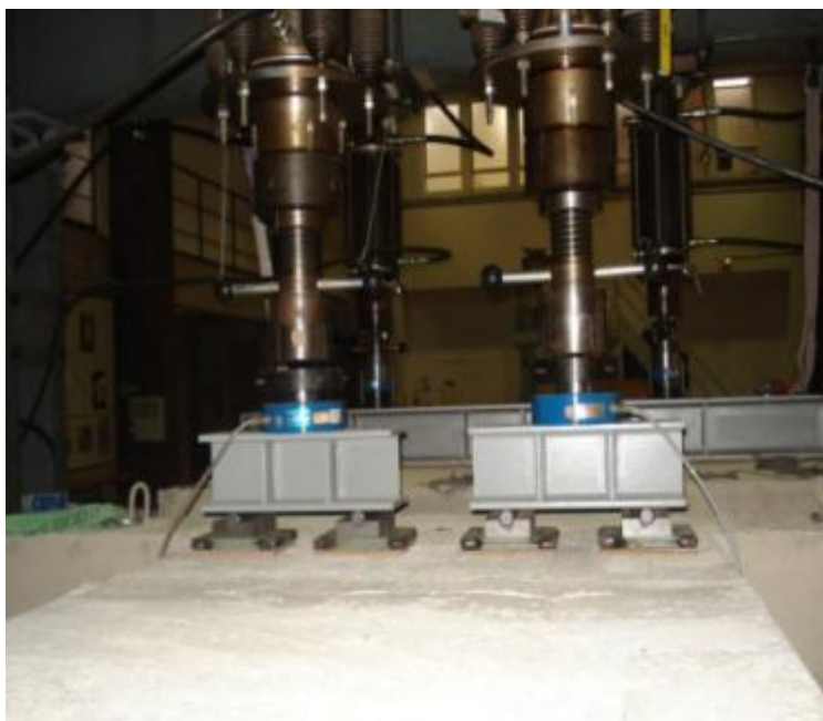
Photo 6 : Mesure en continu de l'effort au vérin (capteur de force sous les vérins).
