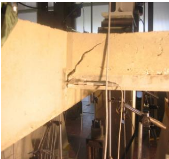
Photo 19 : Vue latérale : fissure inclinée sur l'épaisseur du plancher
