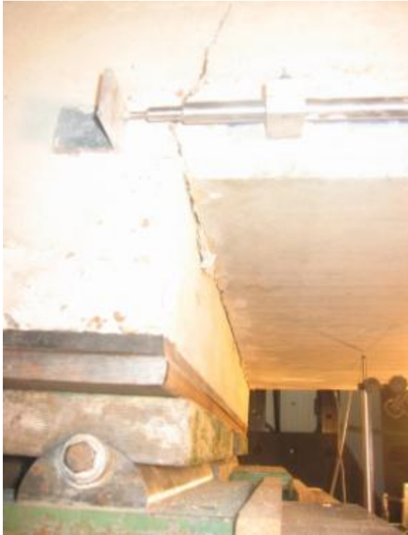
Photo 1 : Appui linéaire formant articulation (côté chargement)
