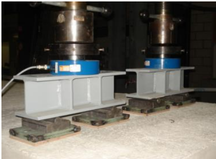
Photo 5 : Le chargement est réalisé à l'aide de deux vérins de 500 kN axés à 20 cm du nu intérieur de la poutre, et munis d'un capteur de force. Un ensemble de poutres de transmission assure une répartition uniforme de la charge malgré la flexion transversale de la dalle. Le pilotage des vérins se fait en déplacement.
