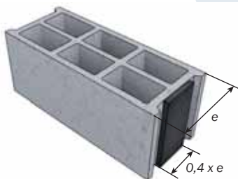
Caractéristiques du joint vertical rempli
