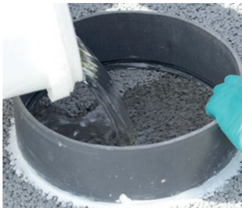
Photo 62 - Mesure de la vitesse d'infiltration in situ selon la norme ASTM C1701.
