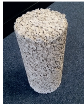
Photo 63 - Carotte de béton drainant pour réaliser des contrôles de porosité et de résistance mécanique.
