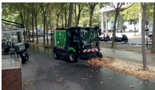
Photo 90 - Balayage et aspiration.
