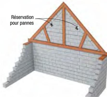
Les appuis des pannes doivent être rendus glissants par interposition de platine métallique ou de contre-plaqué. Des sabots métalliques fixés par chevilles métalliques à expansion dans le béton du chaînage peuvent être utilisés par exemple.
