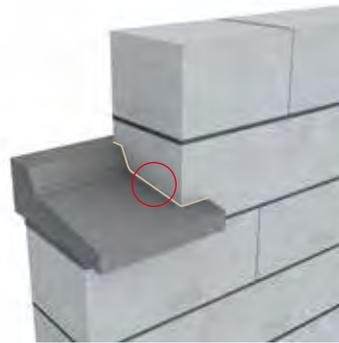
Pour contrer le phénomène de dilatation de l'appui de fenêtre et de la structure, qui entraînerait des micro-fissures source de dégradation ultérieure de l'appui et de l'enduit, il est conseillé de placer du polystyrène ou de la mousse d'une épaisseur de 5 mm aux extrémités de l'appui et de reboucher à l'aide de mortier bâtard les réservations en tableau.
