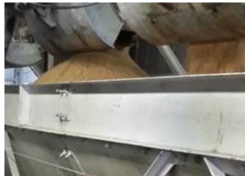
Étape 1 - Ouverture casques ou commande bascule pour chargement à M max avec produit pesé.
