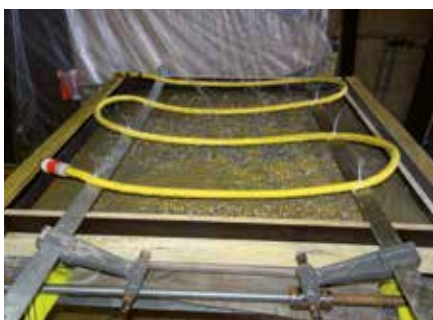
Essai de détermination du coefficient de perméabilité
