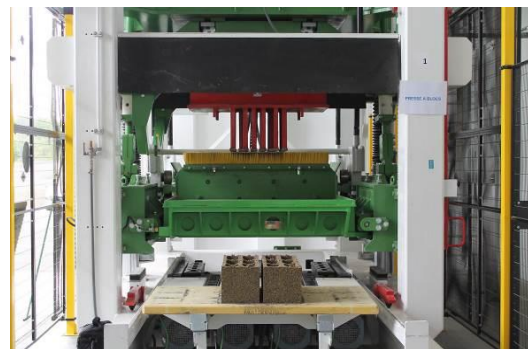
FIGURE 2. Presse vibrante du Cerib
