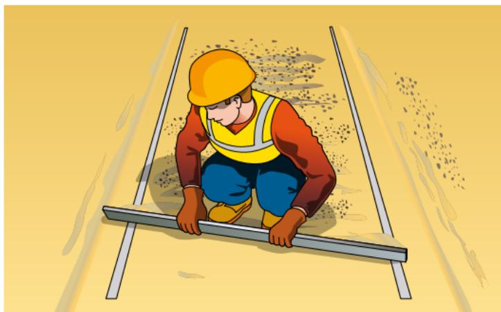
En cas de forte pente, il convient d'utiliser du sable stabilisé avec 75 à 100 kg de ciment/m<sup>3</sup> de sable sec maxi, sans apport d'eau.
