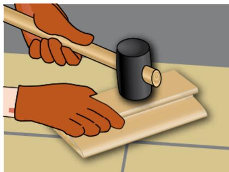
Les produits de dallage sont alignés à l'aide d'une règle et de cordeaux et sont fixés au pilon et à la batte au fur et à mesure de l'avancement avant le début de la prise du mortier.
