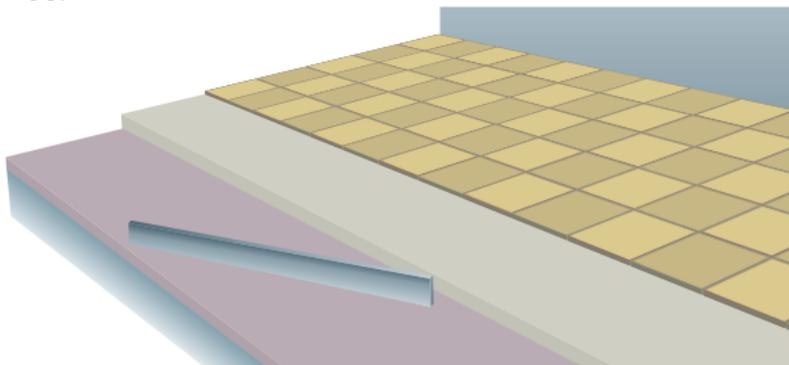
Les produits de dallage sont posés par bandes sur un bain soufflant de mortier : pose bien serrée des produits de dallage sur un lit de mortier frais qui reflue en surface à travers les écartements réservés pour les joints.
