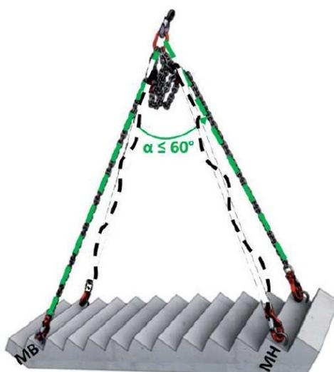
Figure 12 – Nombre d'inserts pris en compte lors de la phase de déchargement et stockage à plat des escaliers droits (MB : marche basse, MH : marche haute)
